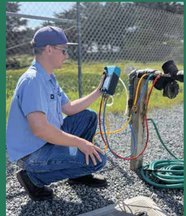
(Hình trái) Nhân viên vận hành thao tác với máy phát điện để đảm bảo dịch vụ không bị gián đoạn khi mất điện. (Hình trên) Nhân viên vận hành kiểm tra thiết bị ngăn dòng chảy ngược để đảm bảo chức năng phù hợp.
