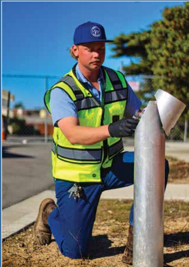
MCWD 작업자가 배수 시스템에서 정기 수질 표본을 채취하는 모습
