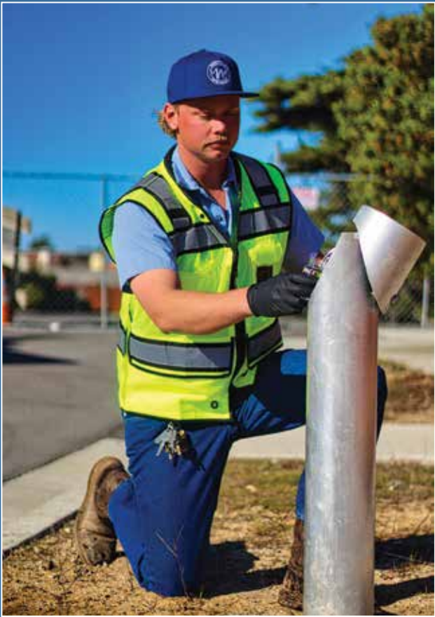
Operador de MCWD tomando una muestra de agua de distribución de rutina
